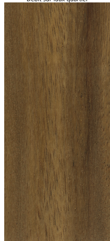
Débit sur faux quartier
